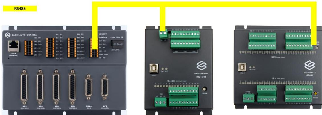
图 2.1.1. I0 模块接线示意图
