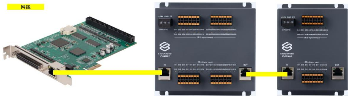
图 2.1.1. IO 模块与 GCE 控制卡接线示意图
